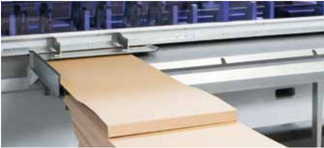
Die Einzelblattzuführung ermöglicht die Zuführung einzelner Verpackungsblätter sowie die Verwendung von Endloskartonage ohne Haspel.
