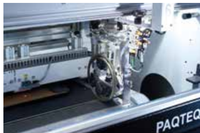
Mit den vollautomatisch zu verfahrenen und schnell zu rüstenden Schneidwerkzeugen kann nahezu jeder Zuschnitt produziert werden.
