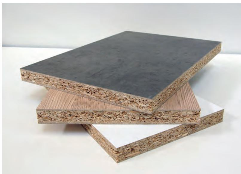
Im Durchlauf kaschierte Werkstücke. Verklebt mit PUR.
